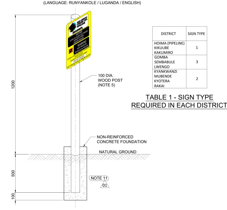
**GROUND MARKER POST** INSTALLATION DETAIL
